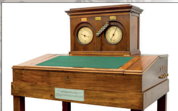
Телеграфный аппарат Б. С. Якоби.
