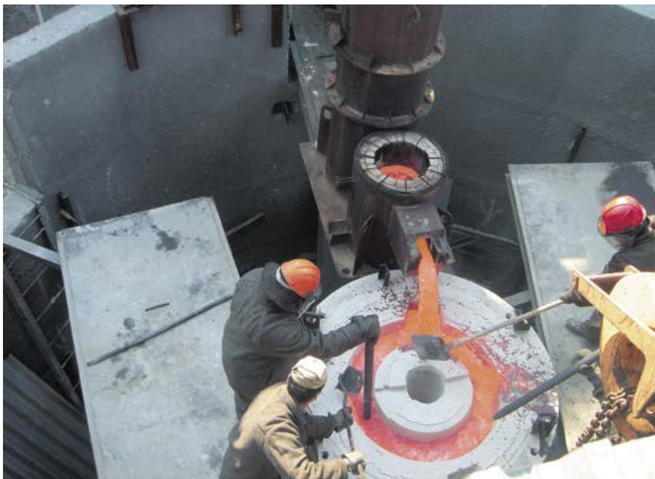
■ Заливка 14-тонного колокола «Мать земли Русской» для Гарварда
