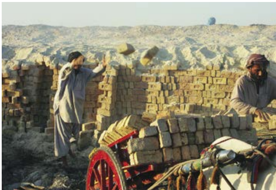
Погрузка кирпичей с одновременной проверкой на прочность
