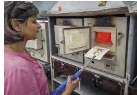
Сегодня «финифтяные штуки» обжигают в современных муфельных печах
