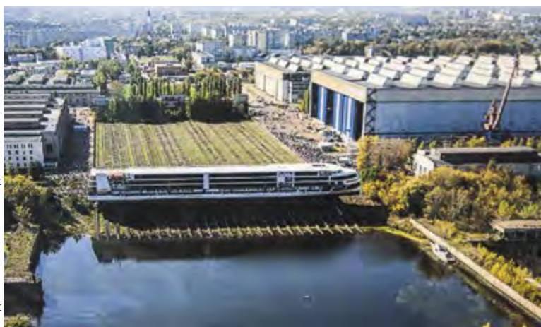
Спуск на воду первого в России четырехпалубного лайнера «Мустай Карим». Длина судна 141 метр – максимальные габариты для заводского затона
